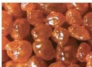
Arena recubierta de resina
